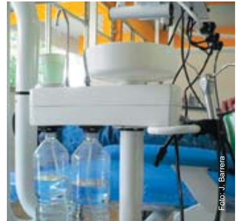
Detalle de una de las nuevas unidades dentales, que muestra el sistema flush con el que están equipadas.
